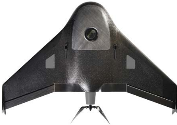
Figura 11: Placa de vientre del Trimble UX5 con cámara
